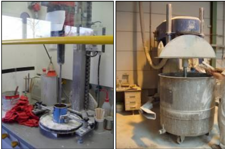
Figuur 4: Proefopstelling toevoegen additief aan lak (links) en de praktijksituatie in de fabriek (rechts).
