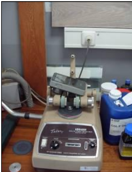
Figuur 13: Meting naar het voorkomen van nanodeeltjes tijdens het uitvoeren van de Taber test met de Taber Abraser.
