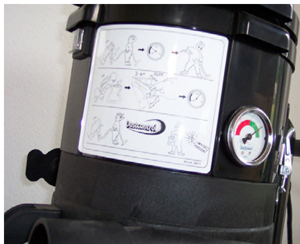
De onderdrukmeter geeft aan wanneer het filter gereinigd moet worden
