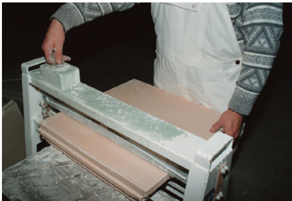
Positief bijeffect: het knippen van gipsblokken geeft minder stof én maakt minder lawaai dan het zagen van gipsblokken
