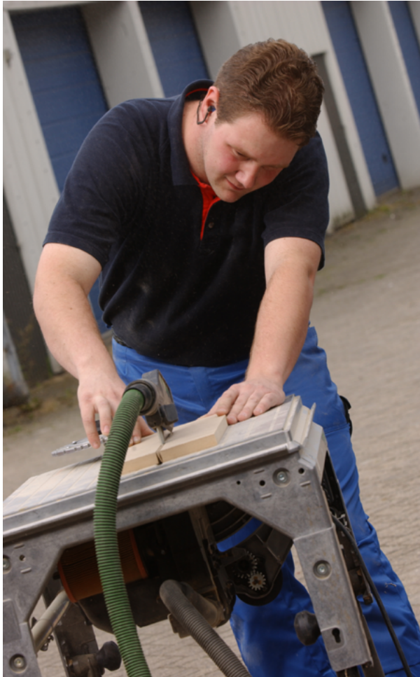
Cirkelzaag met boven- en onderafzuiging
