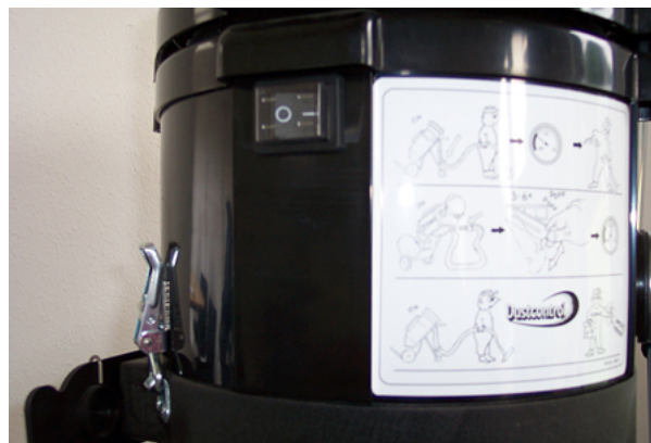
Schakelaars kunnen het beste stofdicht zijn uitgevoerd.
