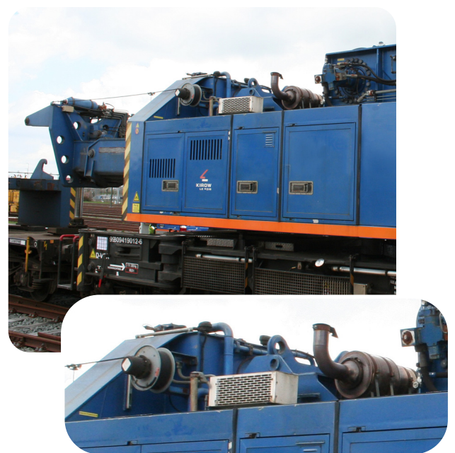
Figuur 5 - Een voorbeeld van materieel dat is voorzien van een roetfilter (zie inzet).
