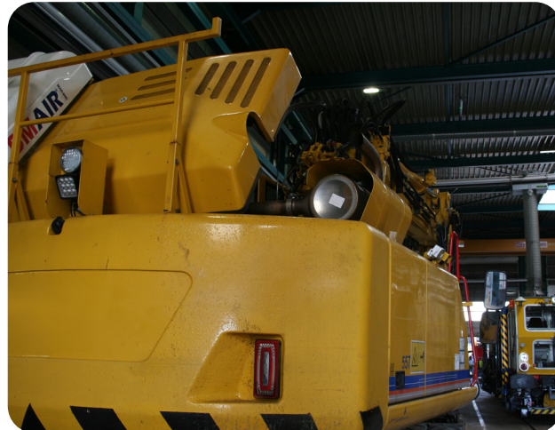
Figuur 6 - Kraan voorzien van een overdrukcabine, de filterunit is links op de foto zichtbaar.
