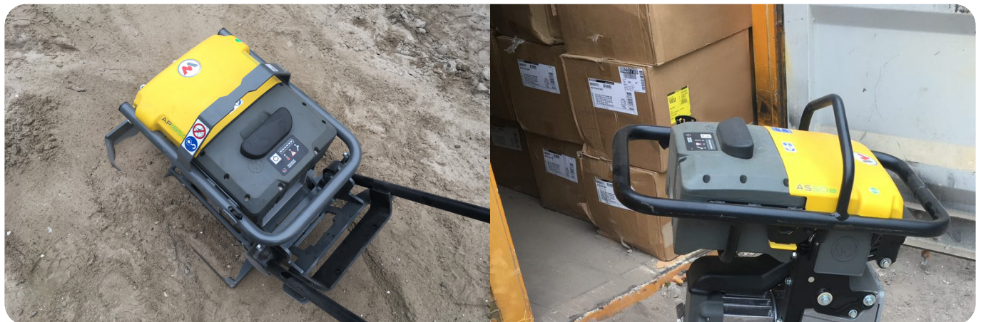
Figuur 4 - Een elektrisch aangedreven trilplaat (links) en een elektrisch aangedreven trilstamper (rechts).
