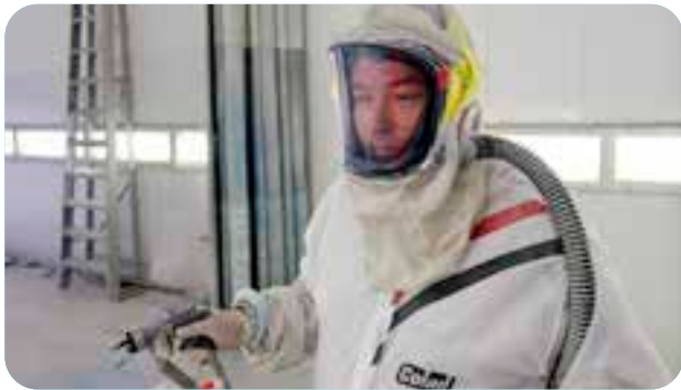
Afbeelding 9 - Aangedreven kap, waarbij ventilator en filter in de kap zijn geïntegreerd
