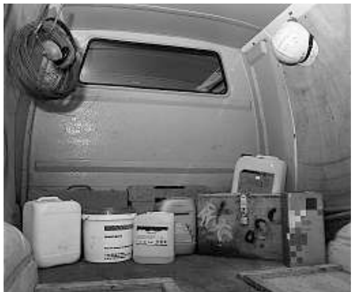
Een dicht schot tussen de cabine en de laadruimte voorkomt klachten.
