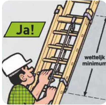
Bij schuifladders moet de minimum overlapping aan de voorschriften van de fabrikant voldoen.
