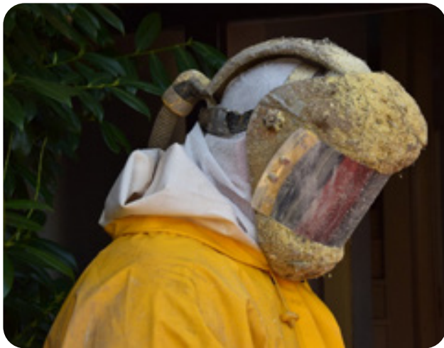
Figuur 3.1 Een overdrukmasker bij het spuiten van PUR.
