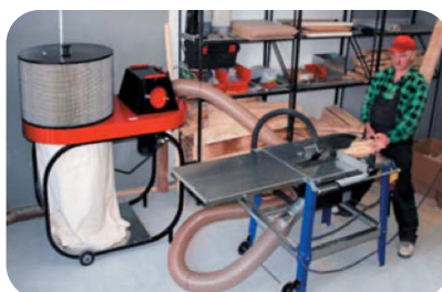
Houtstof afzuiging met voorafscheiding van een bouw cirkelzaag
