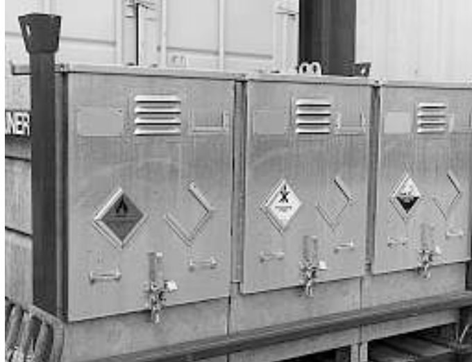
Afvalcontainers moeten duidelijk worden gemarkeerd.
