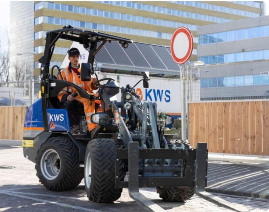
Figuur 8 | Voorbeeld van elektrisch kleinmaterieel: een elektrische shovel
