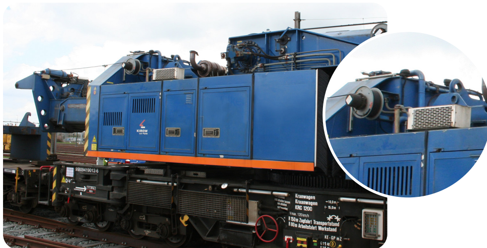
Figuur 5 | Een voorbeeld van materieel dat is voorzien van een roetfilter (zie inzet)
