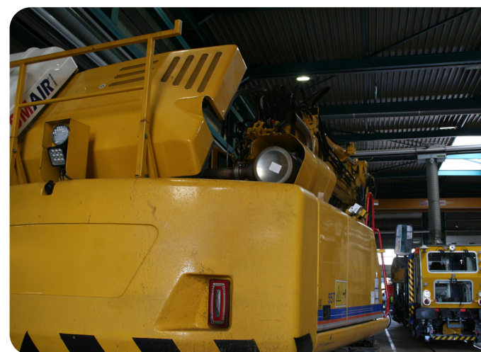
Figuur 7 | Kraan voorzien van een overdrukcabine, de filterunit is links op de foto zichtbaar
