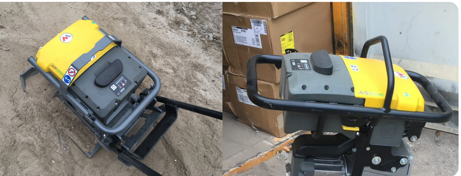
Figuur 4 | Een elektrisch aangedreven trilplaat (links) en een elektrisch aangedreven trilstamper (rechts).
