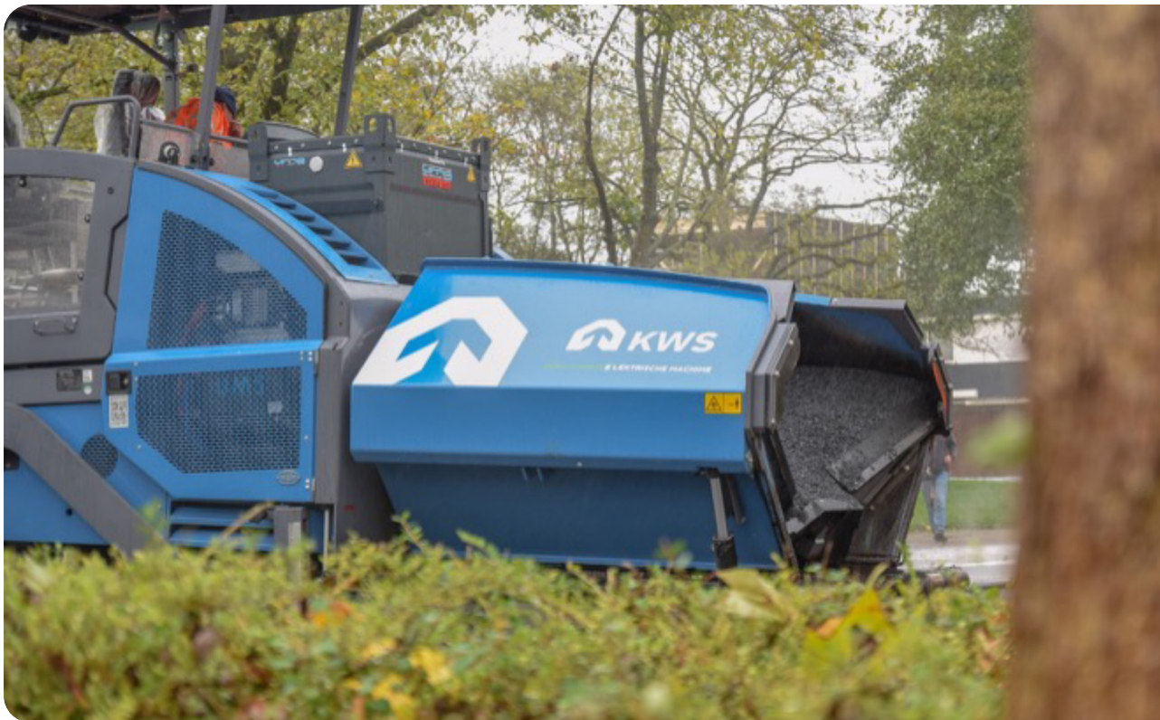
Figuur 3 | Een elektrische asfaltspredmachine, voorbeeld van een non-road machine
